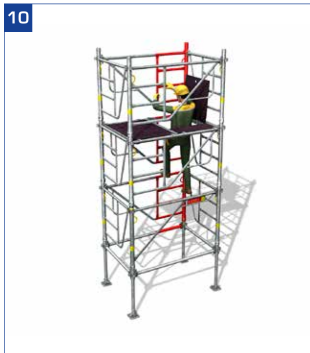
- Le premier niveau de plancher peut être enlevé. Accès au niveau supérieur par l'échelle intégrée.
