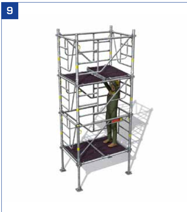
- Déplacement du 2 e plancher à trappe depuis le niveau inférieur.
