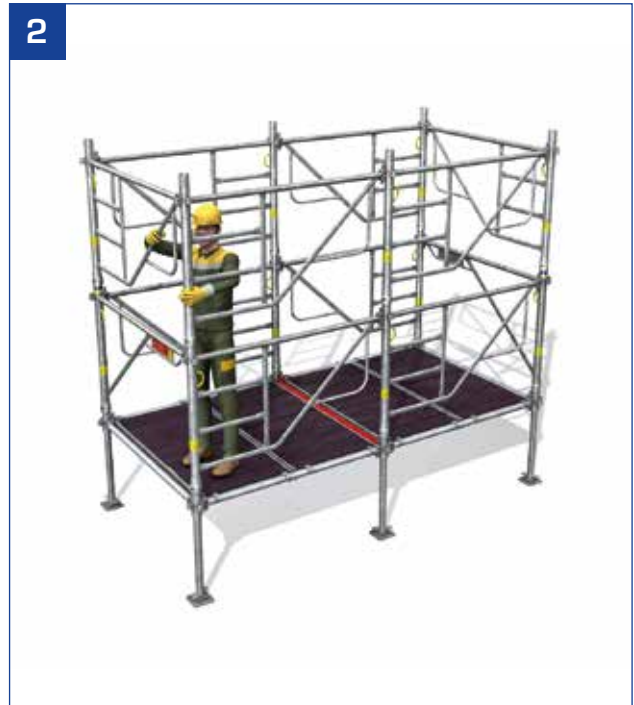
- Montage du 2 e niveau.
