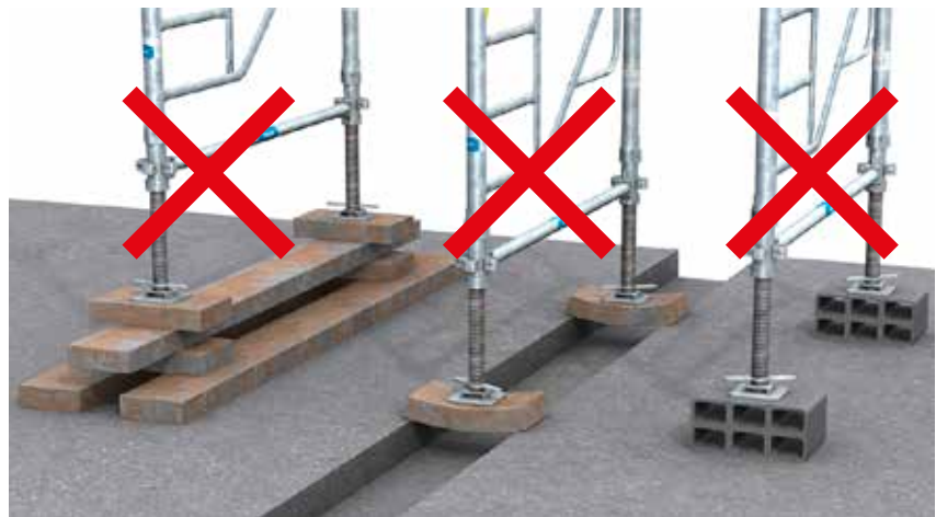
Empilage excessif de cales
