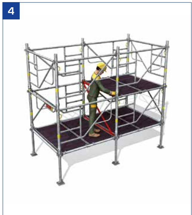
- Contreventement impératif avec une moise et une diagonale.
