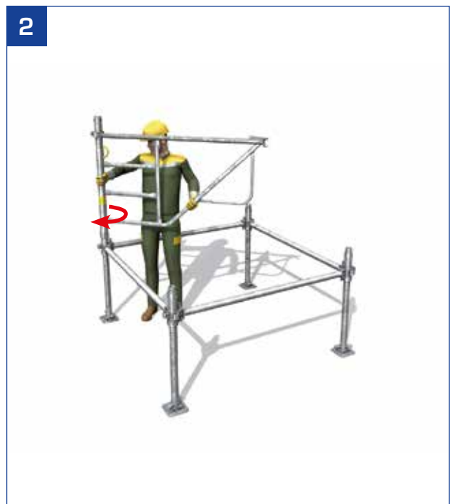
- Depuis l'intérieur de la tour, pose du 1 er cadre dans l'axe de la diagonale puis rotation pour le verrouiller.
